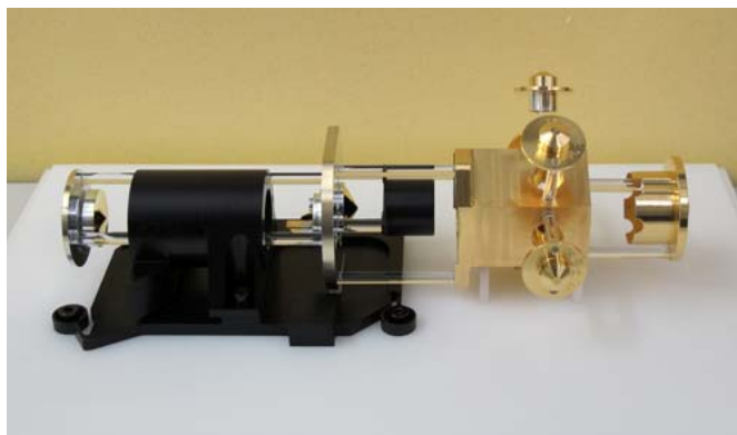
Radio Calibration Spectral Source für NIRSpec des James Webb Teleskops
