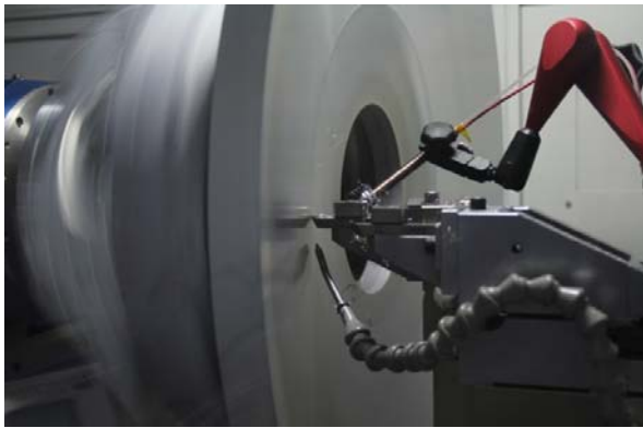
Bild links: Ultrapräzisionsbearbeitung des 60 cm-Spiegels Bild rechts: CAD-Zeichnung des Spiegels mit Aufhängung
